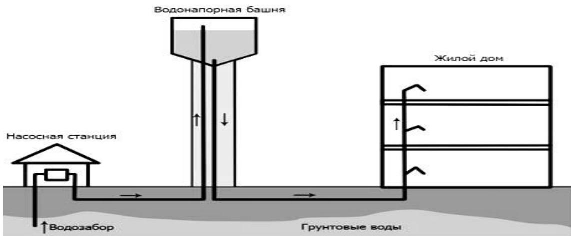
Рисунок 1.1 Упрощенная схема водоснабжения СП Таволжанка
