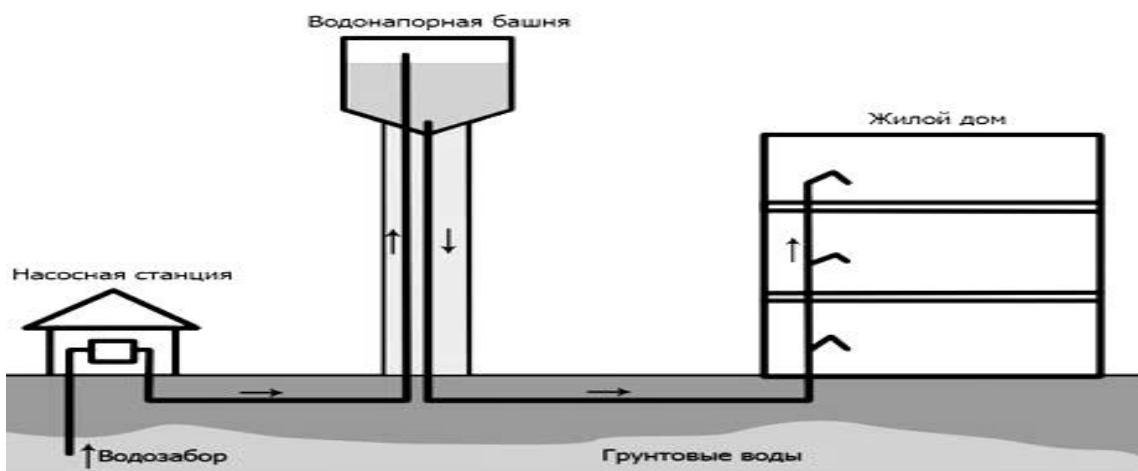
Рисунок 1.1 Упрощенная схема водоснабжения СП Долматовка
