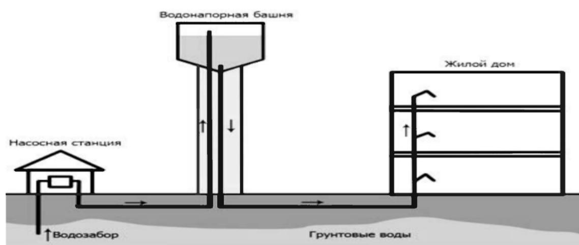
Рисунок 1.1 Упрощенная схема водоснабжения СП Коноваловка
